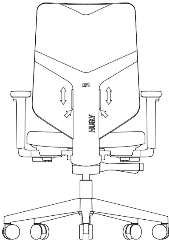
**Armlehnenhöhenverstellung und -breitenverstellung |** Armrest height and width adjustment | Réglage de la hauteur et de la largeur des accoudoirs | Hoogte- en breedteverstelling armleuning
