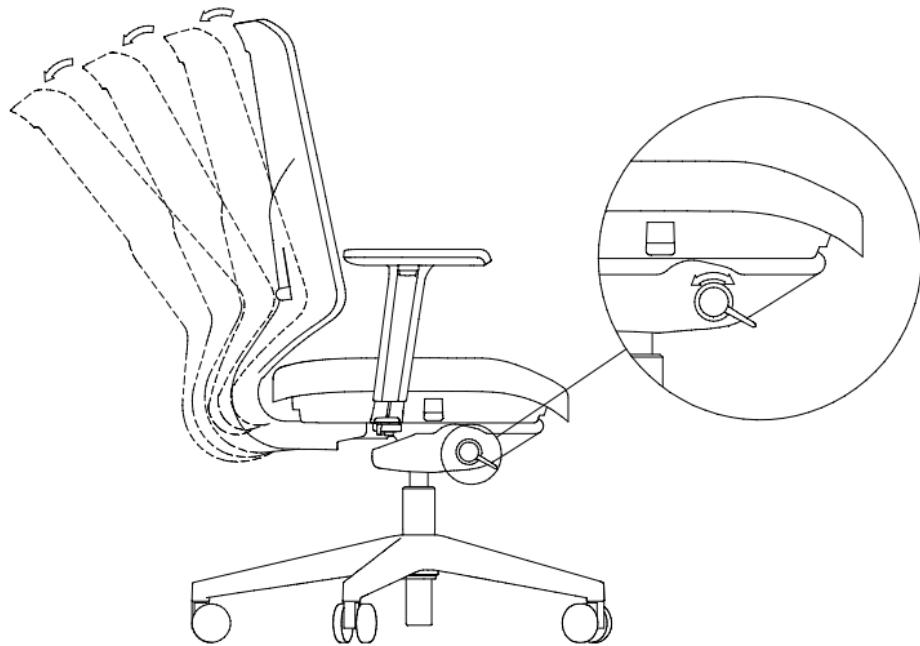
**Sitztiefenverstellung |** Seat depth adjustment | Réglage de la profondeur du siège | Zitdiepteverstelling
